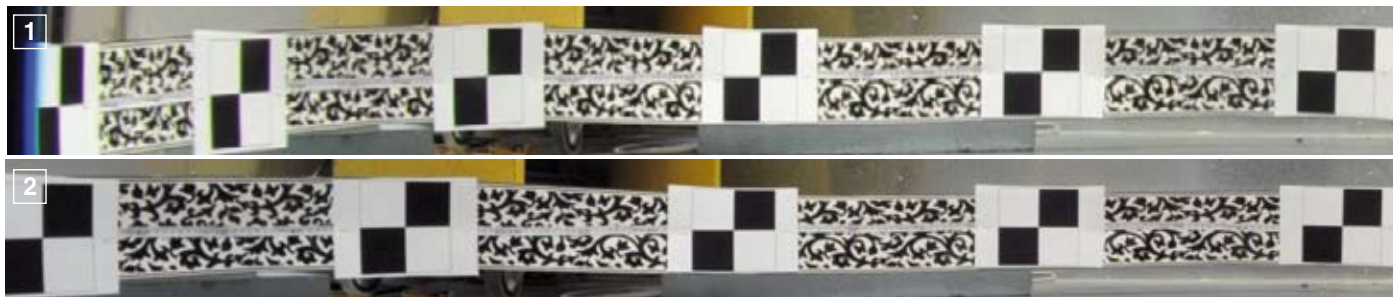
1) Das zirkulare Fisheye von Sigma (oben) arbeitet mit der „Equisolid Angle“-Projektion und deckt in jeder Richtung echte 180 Grad ab – auch die sechste Markierung wird bis zum linken Rand abgebildet. Die Quadrate am Rand behalten ihre Fläche, werden aber gestaucht. 2) Das Walimex-Fisheye verwendet eine äquidistante Projektion: Die im gleichen Winkelabstand von jeweils 18 Grad angebrachten Passer-Marken werden auch etwa im gleichen Abstand auf dem Bild wiedergegeben. Die Quadrate behalten ihre Form, werden aber zum Bildrand etwas größer. Der Bildwinkel ist etwa 148 Grad horizontal (Bild) und erreicht erst auf der Diagonalen 180 Grad.
